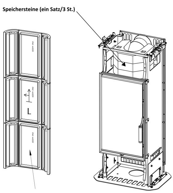
Linkes Seitenteil "L" – die Pfeile zeigen die Richtung der Platzierung von dem Seitenteil an den Korpus (nach oben zur Deckplatte und nach vorne zur Türe).
